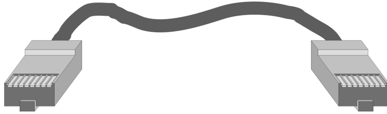
"gekreuztes"-Kabel für den Einsatz von 10 Base-T mit RJ-45-Verbindern
