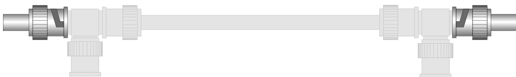
Verbindungsabschluss beim 10 Base-2-Netzwerk
